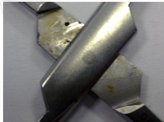
Abbildung 2 Kreuz einer Strabismusschere mit Korrosion
